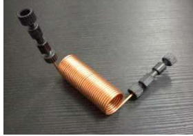
コイルリアクタ (銅 外径1/16" 内径1.0mm)
