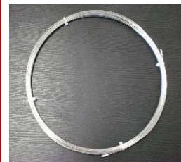
SUSチューブ(10m巻き 外径1/16")
