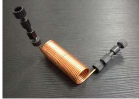
コイルリアクタ (銅 外径1/16" 内径1.0mm)
