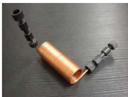
コイルリアクタ (銅 外径1/16" 内径1.0mm)
