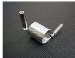
コイルリアクタ (SUS316 外径1/8" 内径1.0mm)
