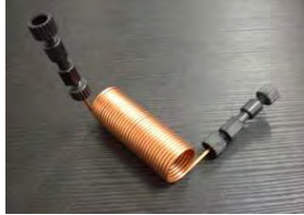
コイルリアクタ (銅 外径1/16" 内径1.0mm)
