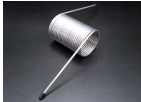
コイルリアクタ (ハステロイC276 外径1/8 内径1.78mm)
