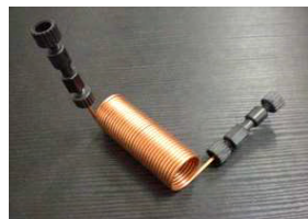
コイルリアクタ (銅 外径1/16" 内径1.0mm)
