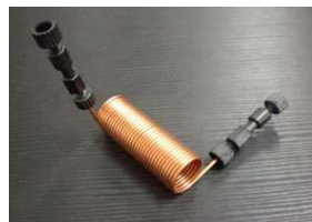
コイルリアクタ (銅 外径1/16" 内径1.0mm)
